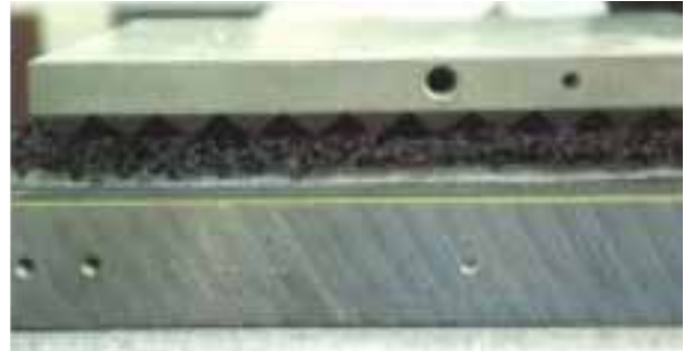
Mise en place du test de pression continue; de haut en bas: Plaque ondulée, matériau de drainage, membrane d'étanchéité, plaque de pression lisse
