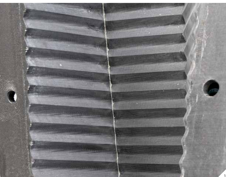
1 Die 2.4 m hohe Betonsäule mit komplexer Geometrie sowie eine Rippendecke wurden mit 3D-gedruckten Kunststoffschalungen gefertigt.
