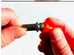
4. Appliquer la buse plate sur l'embout du pistolet
