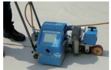
Der Sarnamatic Schweissautomat sorgt für saubere und dauerhaft dichte Nahtverbindungen.
