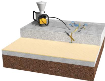
Falls sich unter einem Betonriss eine Fehlstelle im SikaProof® A+ bzw. SikaProof® P befindet, versagt das System.
