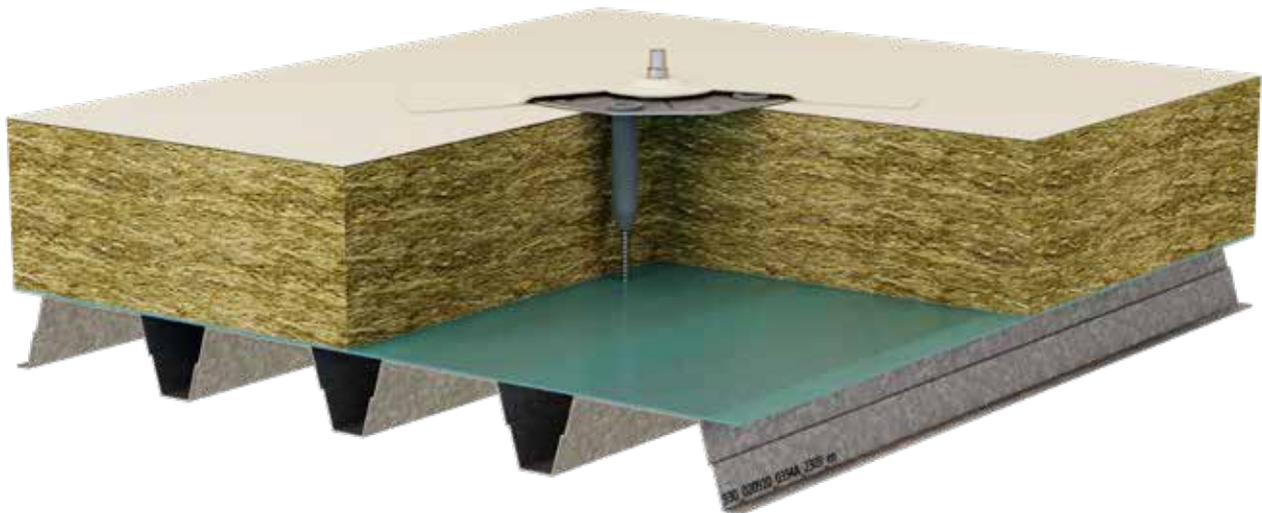
SikaRoof® Anchor Washer 140 mm fixiert mit Sarnafast® Befestigung SBF-6.0 und Sarnabar® Tube SBT-20. Dieses System wird verwendet, wenn die Druckfestigkeit der Wärmedämmung knapp unter 120 kPa liegt. Die maximale Last pro Anker muss entsprechend reduziert werden.
