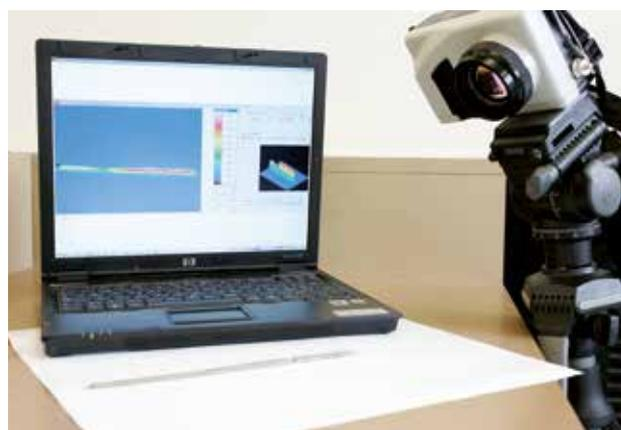
Sika System Engineering assiste l'optimisation de l'application de colle par des méthodes de test brevetées. L'image du haut montre une caméra infrarouge mesurant la chaleur de réaction des colles.
