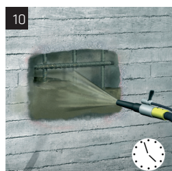
Applicazione della malta fresco su fresco Riprofilamento Meccanicamente oppure a mano: Sika MonoTop-4012, 6-125 mm; Sika MonoTop-412 NFG, 6-50 mm; Sika MonoTop-352 N, 4-75 mm; Sika MonoTop-422 PCC, 6-60 mm;
