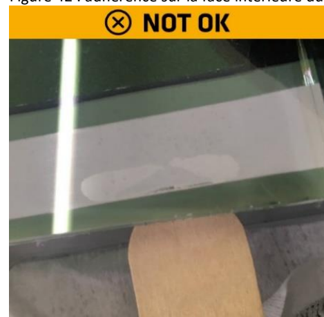
Figure 44 : résultat – perte d'adhérence sur la surface du verre (pas OK)
