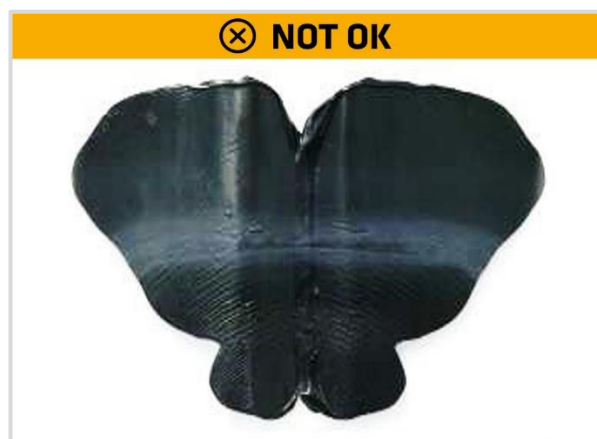
Figure 7 : déplier la feuille - test négatif = mélange insuffisant
