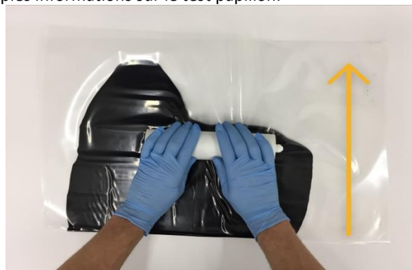
Figure 5 : presser le cordon perpendiculairement au pli
