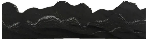
Figure 11 : stries blanches manifestes dans le matériau, mélange inhomogène
