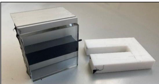
Figure 20 : enlever l'écarteur en U en téflon blanc après le temps de durcissement correspondant (voir ci-dessus).
