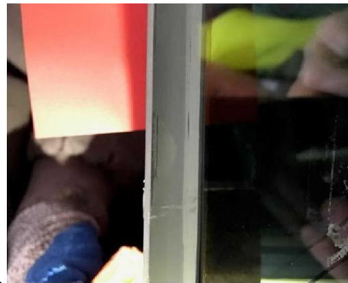
Figure 42 : adhérence sur la face intérieure du verre (OK)
