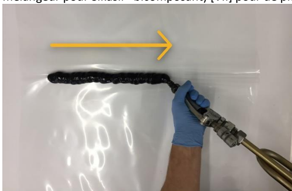
Figure 4 : appliquer un cordon de colle sur le pli
