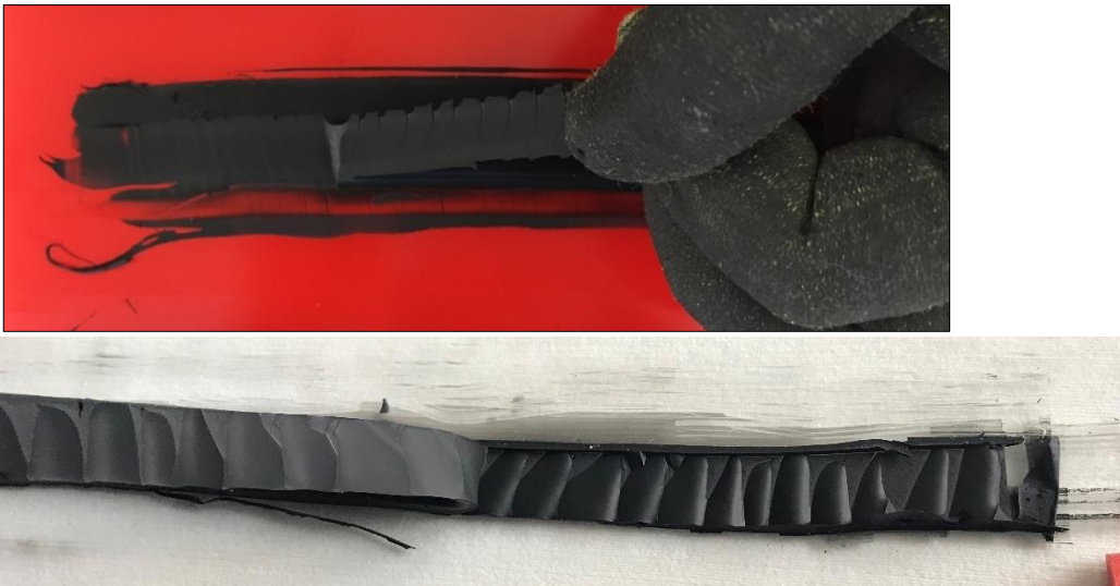
Figure 14 : test d'adhérence du cordon par pelage : tirer le cordon du support, rupture de cohésion 100%.
