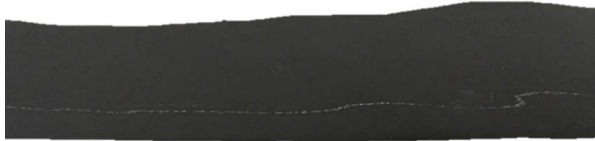
Figure 10 : stries blanches dans le matériau, mélange inhomogène
