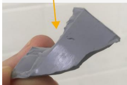
Figure 38 : pas d'adhérence sur les faces intérieures des vitres, pas OK
