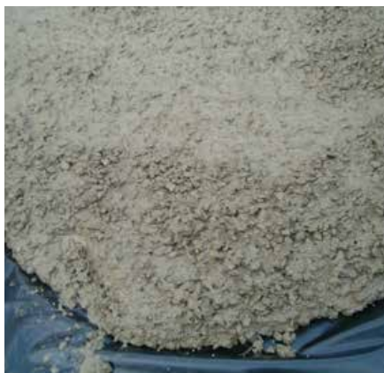
Abb. 4.1.1: Frischbeton ohne Zusammenballen
