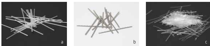
Abb. 5.3.1: a) Gerade geprägte Fasern b) Gewellte Fasern c) Weiche, flache Fasern
