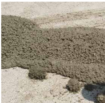
Abb. 4.1.2: Frischbeton mit Igel-Bildung
