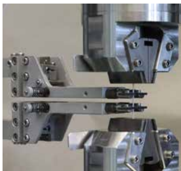
Abb. 4.4.1: Universalprüfmaschine mit Flachklemmensystem und taktilem Dehnungsmesser für eine sehr genaue Bestimmung der Dehnung
