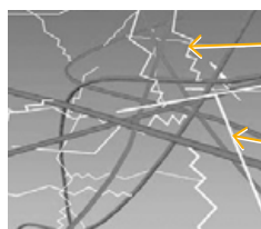
Abb. 5.2.3.1: Netz aus Mikrorissen
