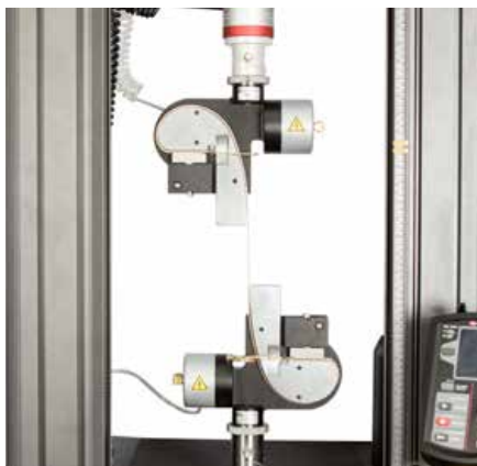
Abb. 4.4.1.2: Selbstspannende Klemmvorrichtung gemäss ASTM D 2256-02
