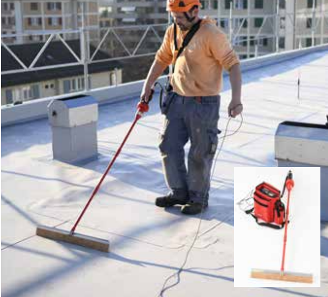
Hochvolt-Prüfung: Dach muss TROCKEN und OHNE Schutz-/Nutzschicht sein!
