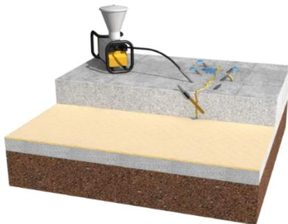
Au cas où sous une fissure dans le béton se trouve un défaut dans le SikaProof® A+ resp. SikaProof® P, le système ne fonctionne plus.
