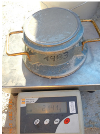
SikaScreed® Controllo di qualità: Densità grezza CTF ~ 2150 kg/m³
