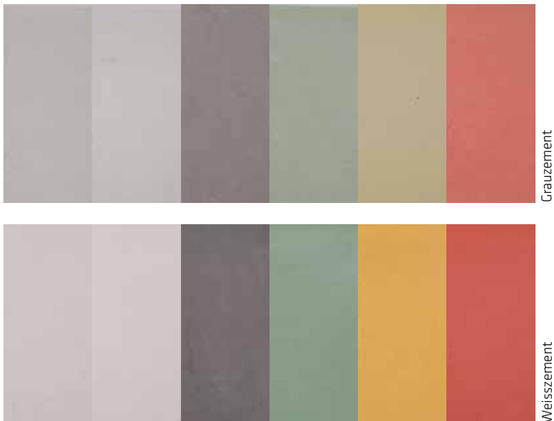
Abb.10: Einfluss der Zementfarbe auf die Betonfarbe
