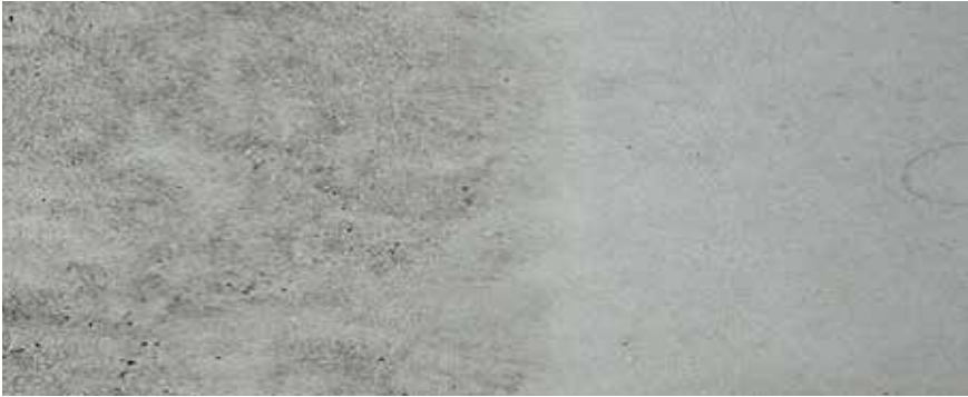
Abb. 7: Folgen einer zu grossen Auftragsmenge (links) und der richtigen Auftragsmenge (rechts) des Trennmittels
