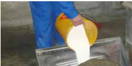
Abb. 17: Dosierung von Sika® ColorCrete G auf das Förderband
