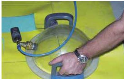
Lors d'un contrôle sous vide, une cloche de contrôle est posée sur le cordon de soudure ou les raccords. L'air de la cloche est aspiré afin de provoquer une sous-pression.
