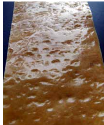
Campione di PVC della galleria Caverna sul Monte Ceneri del 1969
