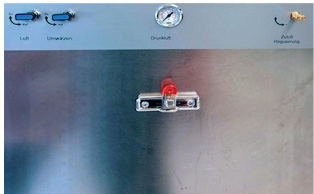
Die Umwälzanlage und die Feineinstellung der Pumpe werden über Regler eingestellt.
