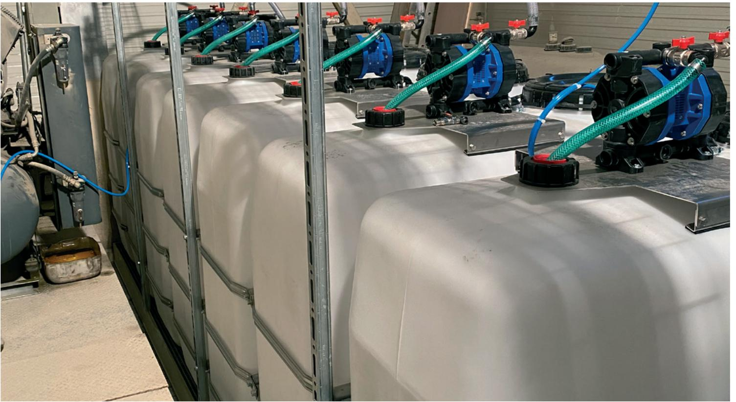
Für die Betonwerke in Castione und Piotta wurden neue Tanks für die Lagerung von Zusatzmitteln eingebaut.
