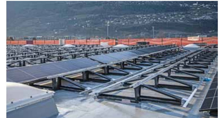
Sika® SolaRoof® est la solution système Sika pour les toitures plates avec installations photovoltaïques. Il offre un système de montage simple qui est soudé directement sur l'étanchéité de toiture Sika à l'aide de quelques outils seulement, sans la moindre pénétration. Avec son poids léger, Sika® SolaRoof® peut également être utilisé sur des constructions de toiture où le poids est un élément critique.
