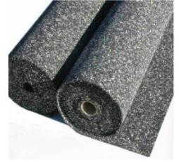
Lo strato di protezione Sarnafil è la protezione ideale contro i danneggiamenti meccanici dei manti Sarnafil T e Sarnafil PVC (soprattutto in presenza di carichi elevati, p.e. per coperture carrabili). Su coperture in Sarnafil PVC, per motivi di compatibilità, è richiesta la posa di uno strato di separazione, p.e. Sarnafelt T 300 oppure Sarnafelt VS 140.
