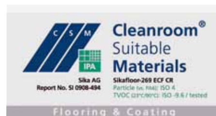
Bild 4: Label eines CSM-geprüften Bodenbelages mit ISO-Klassierung.
