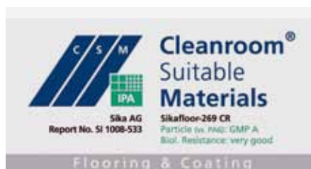
Bild 3: Label eines CSM-geprüften Bodenbelages mit GMP-Klassierung.
