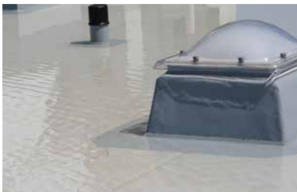
Sicurezza aggiuntiva per il controllo dell'impermeabilità mediante invaso d'acqua al momento del collaudo del tetto
