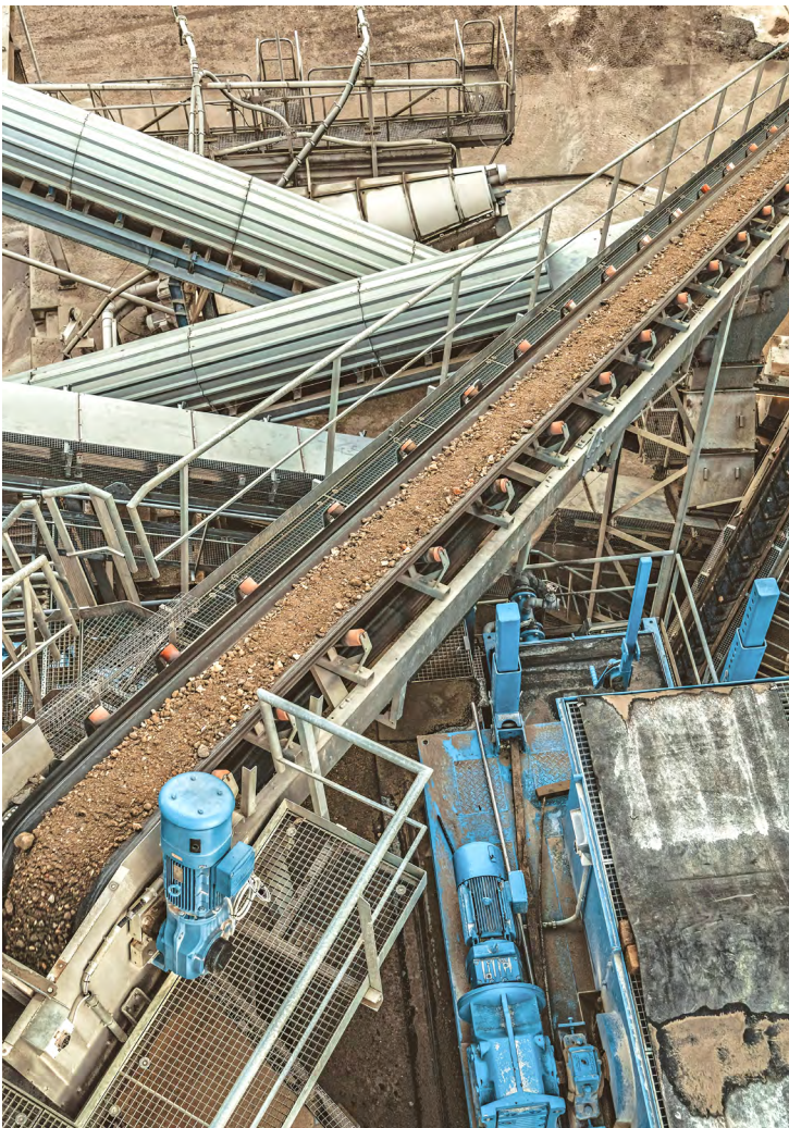
Das Kieswerk der Richi AG verfügt über eine hochmoderne Nasswaschtechnik. Mischabbruch wird hier zu hochwertigen Produkten aufbereitet. (Bilder: Richi AG)
