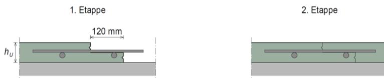
Abb. Nr. 35: Konstruktive Details für die Ausbildung von Arbeitsfugen in UHFB (II)
