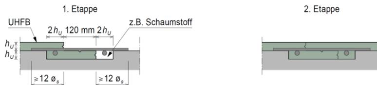
Abb. Nr. 34: Konstruktive Details für die Ausbildung von Arbeitsfugen in UHFB (I)
