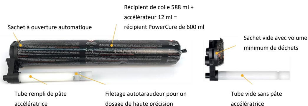
FIGURE 5 Sachet PowerCure (Sikasil® WT-66 PowerCure) avant utilisation et une fois vidé
