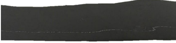
Figure 16 : stries blanches dans le matériau, mélange inhomogène
