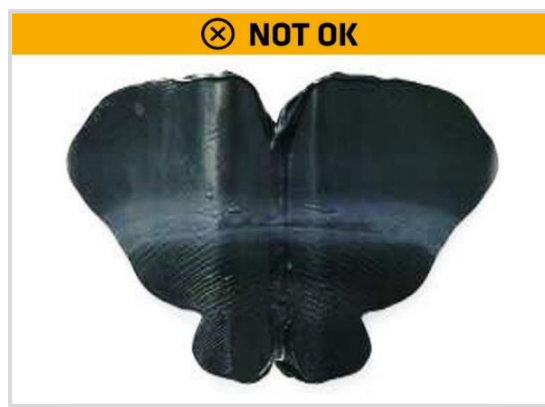
FIGURE 12 Déplier la feuille - Test négatif = mélange insuffisant
