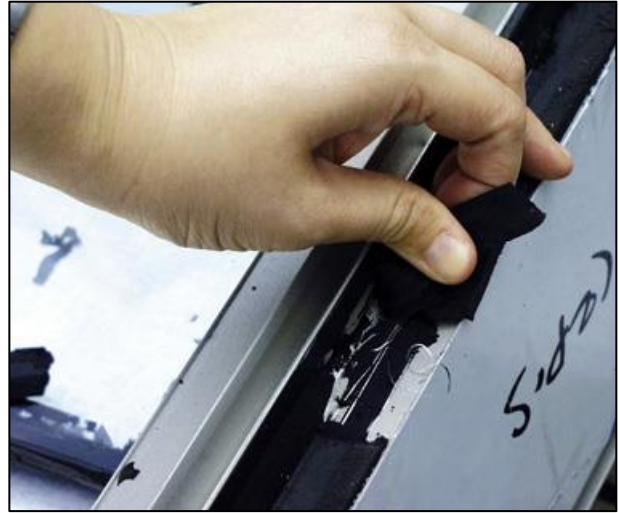
Figure 32 : défaillance de la colle, le test de dévitrification n'est pas en ordre
