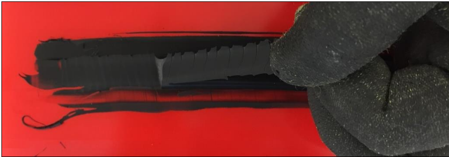
Figure 29 : test d'adhérence du cordon par pelage : tirer le cordon du support, rupture de cohésion 100 %.
