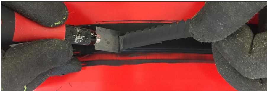
Figure 30 : test d'adhérence du cordon par pelage sur verre émaillé : le cordon est entaillé tout en tirant dessus.
