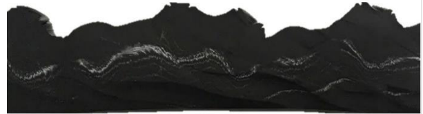
Figure 17 : stries blanches manifestes dans le matériau, mélange inhomogène
