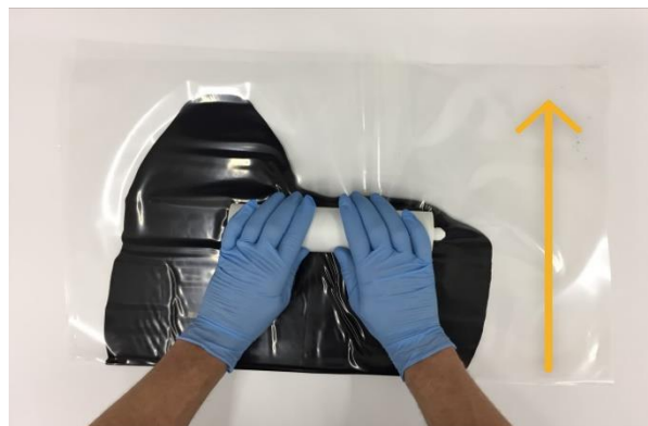
FIGURE 10 Appuyer sur le cordon de colle uniquement perpendiculairement au pli
