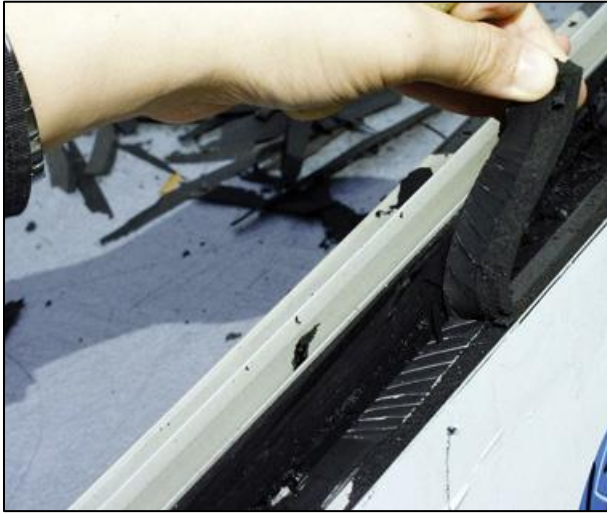
Figure 31 :bonne adhérence (adhésion), test de dévitrification réussi
