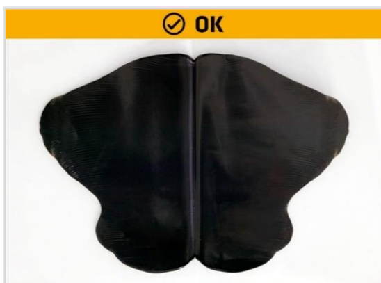
FIGURE 11 Déplier la feuille - Test positif = mélange idéal
