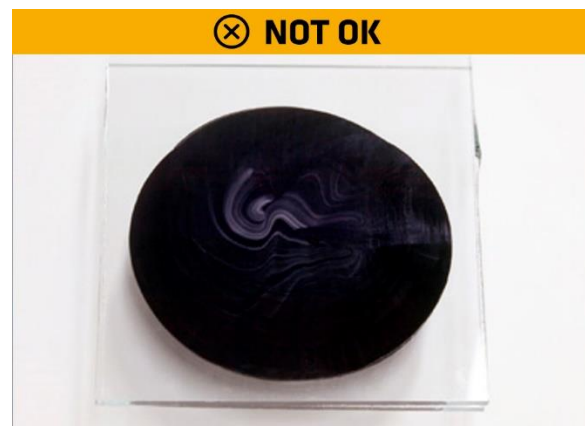
FIGURE 8 Test négatif = mélange insuffisant
