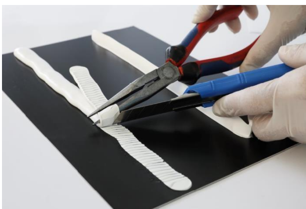
Figura 5: torcere il cordone di adesivo per ottenere tensione e taglio massimi.
