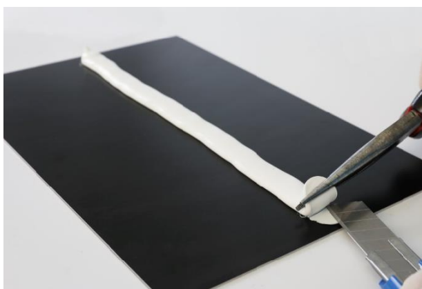
Figura 4: attendere l'indurimento completo, poi tagliare i primi 3 cm di cordone.
