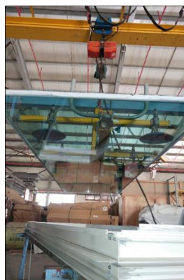
Abbildung 36: Glas wird vom Rahmen entfernt
