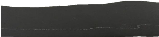
Abbildung 11: Weisse Streifen im Material, inhomogene Mischung
