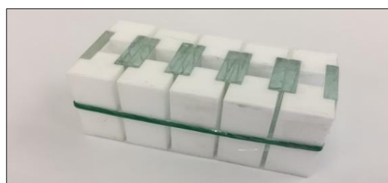
Abbildung 29: Anordnung und Fixierung der H-Prüfkörper mit Gummiband und Klebeband (transparent).
