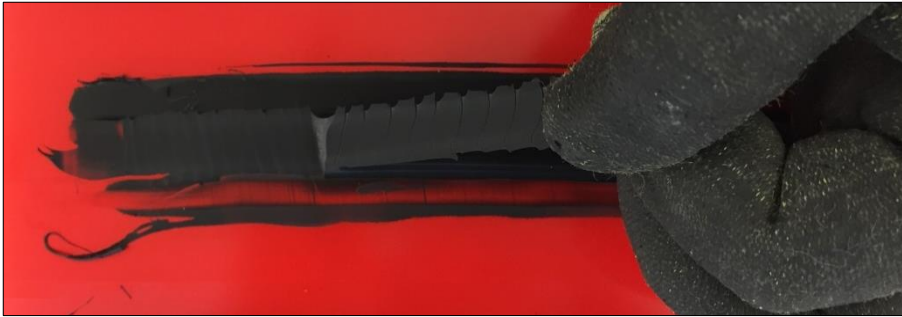
Abbildung 20: Raupenschältest: Ziehen der Raupe vom Untergrund, 100 % kohäsives Bruchbild.
