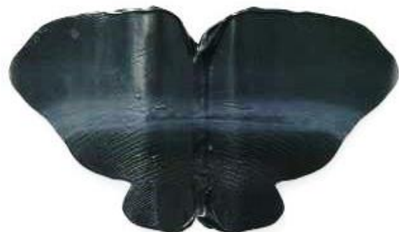
Abbildung 8: negativer Test = ungenügende Mischung
