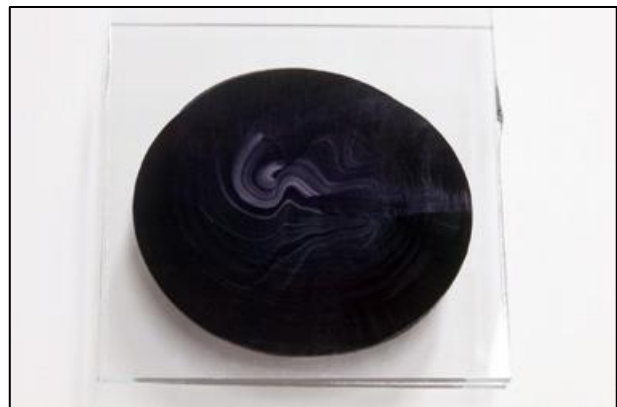
Abbildung 4: Negativer Test = Mangelhafte Mischung
