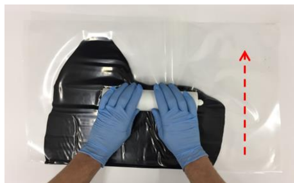
Abbildung 6: Raupe senkrecht zum Falz verpressen
