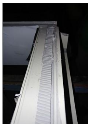
Abbildung 37: Prüfen der Haftung entlang des gesamten Rahmens – Gutes Haftergebnis
