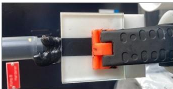
Abbildung 24: H-Prüfkörper komplett mit Klebstoff auffüllen, Luftblasen vermeiden
