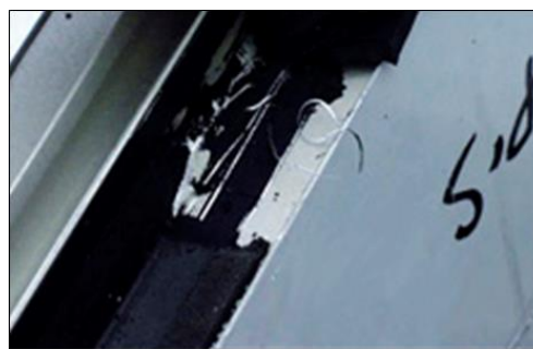
Abbildung 40: Beispiel mit schwarzer SG-Fuge schlechtes Haftergebnis (Haftungsversagen)
