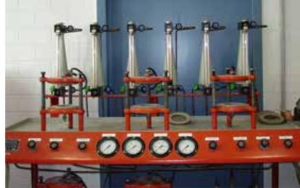
Abb. 8.1.1: Die Wasseraufnahme von Beton unter Druck misst die maximale Wassereindringtiefe in mm nach einer bestimmten Zeit mit einem bestimmten Druck. (72 Stunden bei 5 bar gemäss EN12390-8)
