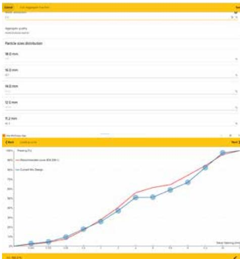
Abb. 4.3.3: Entwurf und Berechnung einer Siebkurve
