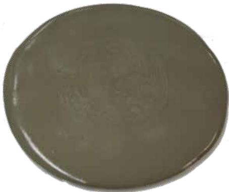
*Der Zementmörtelleim enthält alle Bindemittel, pulverförmige Zusatzmittel und das freie Wasser (welches nicht von den Gesteinskörnungen absorbiert wird).*
