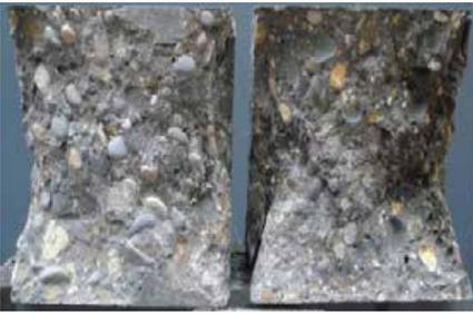
Abb. 8.9.2: Die Unterschiede in der Qualität der Gesteinskörnung und des  $w/z$ -Werts bestimmen, ob am Punkt der maximalen Belastung Risse in der Gesteinskörnung oder im Zementleim auftreten. Das Bild zeigt eine Verringerung des  $w/z$ -Werts von 0.32 (links) auf 0.28 (rechts).
