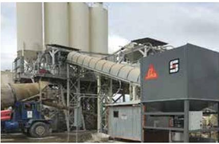
Abb. 8.13.2: Farbbeton erfordert weit mehr als nur die Zugabe der Pigmente. Von der Planung bis zum Einbau müssen wesentliche Entscheidungen für den Erfolg der Anwendung getroffen und die unterschiedlichsten Produktionsschritte geprüft und fachgerecht ausgeführt werden. Das Bild zeigt einen Sika Scofield Granular Color Dispenser in einem Betonwerk.
