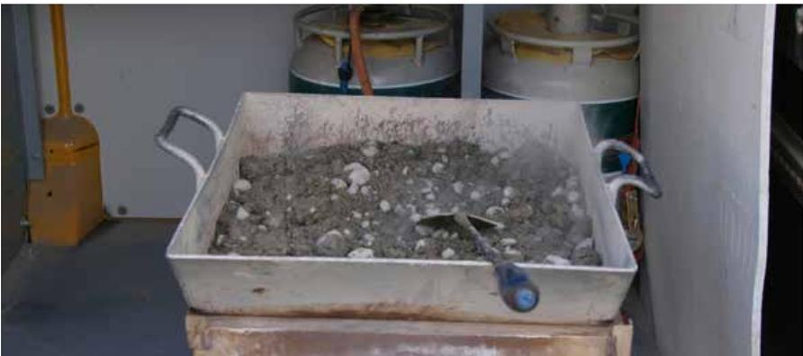
Zur Bestimmung des Wassergehalts in einem Beton werden zwei Methoden verwendet. Das Grundprinzip besteht darin, das Wasser durch Trocknung zu verdampfen. Der Test kann entweder mit einem Gasbrenner oder einer Mikrowelle durchgeführt werden.
