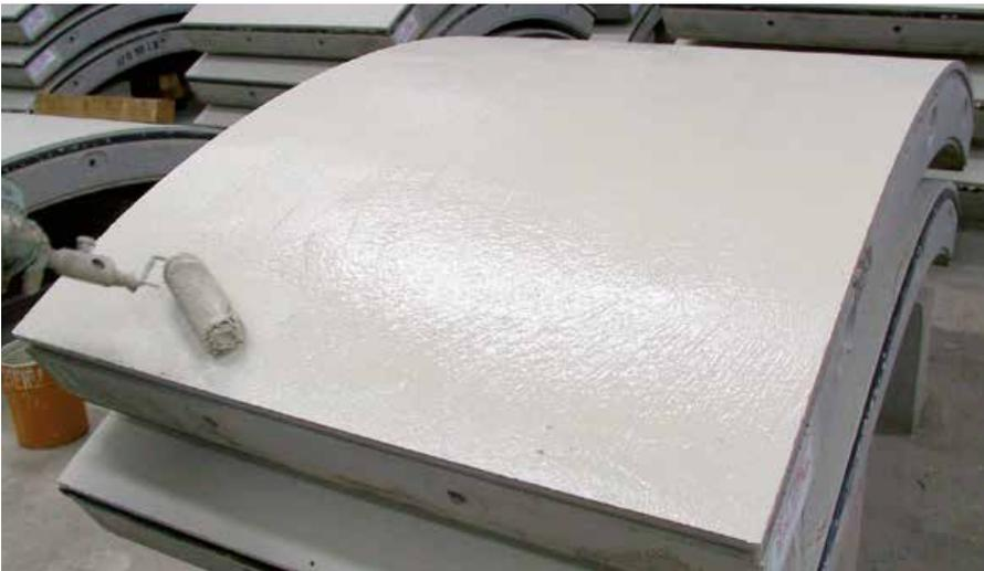
Abb. 8.4.4: Unmittelbar nach der Nachbehandlung in einem Dampfkanal wird die Betonoberfläche der Tübbinge mit einer Epoxidharzemulsion auf Wasserbasis beschichtet, die bis in die kleinsten Poren einzieht und so eine geschlossene Schutzschicht bildet.
