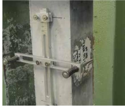
Der statische E-Modul charakterisiert den Verformungswiderstand von Beton gegen eine gleichmässig ansteigende Belastung oder eine Stossbelastung. Der dynamische E-Modul eignet sich zur Untersuchung des Reifegrades von Beton, z. B. des Aushärtungsprozesses oder zur Messung der Witterungseinflüsse bzw. möglicher schädigender Einflüsse (Labor- oder Feldprüfkörper).
