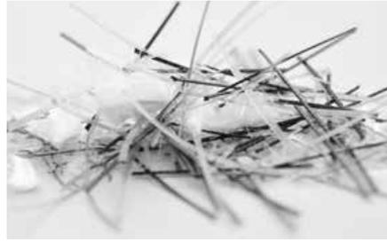
Abb. 8.11.1: Fasern für die Verwendung in Beton werden aus verschiedenen Materialien und Qualitäten hergestellt und können je nach den Anforderungen an den Frisch- oder Festbeton unterschiedliche geometrische Abmessungen und Formen haben.
