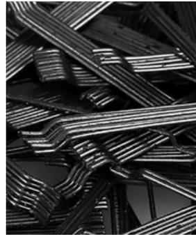
**Stahlfasern** zeichnen sich durch einen hohen E-Modul (200 GPa) und eine hohe Zugfestigkeit (2 500 MPa) aus. Sie verhindern das Kriechen des Betons und wirken nicht gegen das Frühschwinden.
