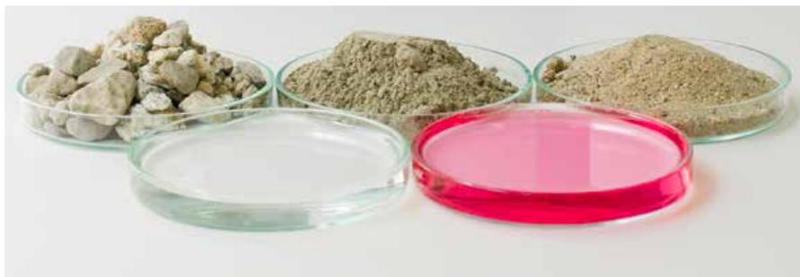
Abb. 4.2.2: Bestandteile der Betonrezeptur: Kies, Wasser, Zement, Hochleistungsfließmittel, Sand (von links nach rechts)
