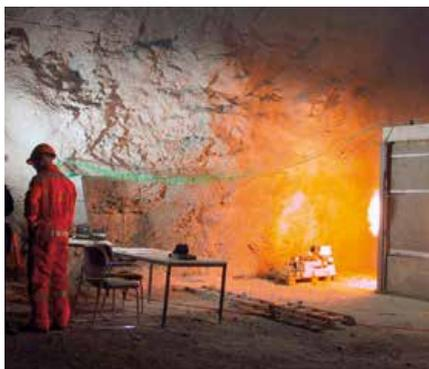
Beton ist das lasttragende Material in fast allen Bauwerken und daher besonders gefährdet, da das gesamte Bauwerk bei einem Versagen des Materials zusammenbrechen würde. Beton muss daher, unabhängig vom Gefahrenszenario, richtig formuliert oder durch äusserliche Massnahmen geschützt werden, um ein Versagen bei hohen Temperaturen im Brandfall zu verhindern.
