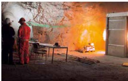
Abb. 8.5.1: In speziellen Brennkammern können Brandverläufe nachgestellt, Platten geprüft und anschliessend bewertet werden. Die Temperaturentwicklung wird in verschiedenen Tiefen gemessen und aufgezeichnet.
