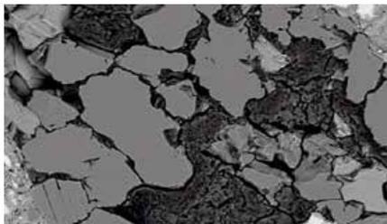
Abb. 8.6.1: Amorphe Kieselsäure in der Gesteinskörnung hat, durch die Reaktion mit Alkaliionen, ein Gel gebildet. Dieses hat sich durch Wasseraufnahme ausgedehnt (schwarz, gerissene Stellen). Dadurch wird im Betongefüge Druck aufgebaut, der zu Rissen führt.
