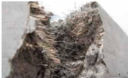
Abb. 8.9.1: Hochfester Beton und vor allem Hochleistungsbeton (ultra high performance concrete, UHPC) ist in der Regel faserverstärkt. Je nach Anforderung werden dabei synthetische Fasern und/oder Stahlfasern in grosser Menge eingesetzt.
