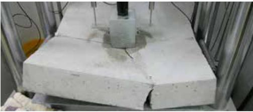
Abb. 8.11.3: Spezielle Prüfungen für Spritzbeton: Prüfung der Energieaufnahme von faserverstärktem Spritzbeton nach EN 14488-5.
