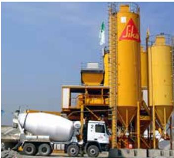
Die Art und Weise der Betonherstellung ist für das Endprodukt von entscheidender Bedeutung und besteht im Wesentlichen aus dem Dosieren und Mischen der Komponenten. Folgenden Parameter können die Betoneigenschaften beim Mischen beeinflussen:
