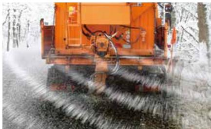
Abb. 8.3.3: Ausgestreutes Taumittel verstärkt die Reaktion beim Gefrieren von Wasser erheblich und führt in oberflächennahen Bereichen des Betons zu wesentlich grösseren Schäden.
