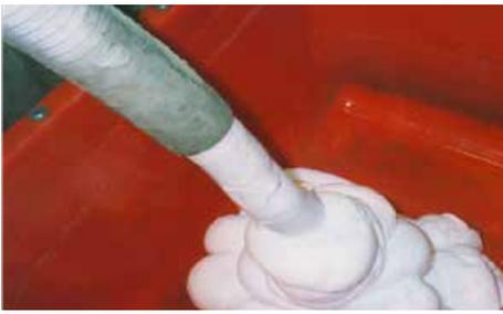
Abb. 8.15.2: Mit einem Schaumgenerator und Sika® Stabilizer erzeugter Schaum zur Herstellung von Poren- / Schaumbeton.
