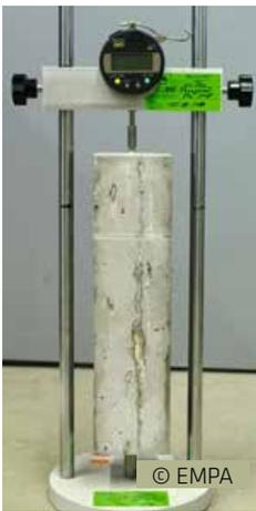
Abb. 8.6.2: Die Volumenzunahme durch die AAR verursachten Dehnung wird durch die Messung der Längenänderung der Prüfkörper bestimmbar. In der Regel werden die Prüfkörper unter verschärften Bedingungen (Temperatur, Feuchtigkeit, Belastung) gelagert, um die Reaktion zu beschleunigen.
