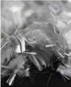
**Synthetische Mikrofasern** haben einen noch niedrigeren E-Modul (3 – 5 GPa) als synthetische Makrofasern. Sie werden hauptsächlich zur Verringerung von Frühschwindrisse und als Brandschutzfasern eingesetzt.
