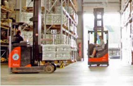
Abb. 8.7.3: Auch Industrieböden sind durch die ständig rollenden und dynamischen Belastungen an denselben Stellen einem starken Abrieb ausgesetzt. Harte Betonbeschichtungen und spezielle Einstreustoffe können die Griffigkeit verbessern und den Verschleiss minimieren.
