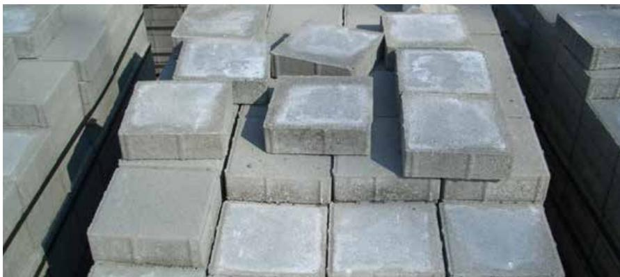
Das Calciumhydroxid wird aufgrund des Konzentrationsgefälles der Calcium-Ionen in der Feuchtigkeit an die Betonoberfläche transportiert. Durch die Reaktion von Calciumhydroxid mit dem Kohlendioxid ( $\text{CO}_2$ ) der Luft entsteht das weisse Calciumkarbonat (Kalkstein). Wasser ist das wichtigste Transportmittel. Je grösser die Wasseraufnahme des Betons (Porengehalt) ist, desto länger ist die Trocknungszeit der Pflastersteine und desto stärker sind die sich daraus ergebenden Ausblühungen.
