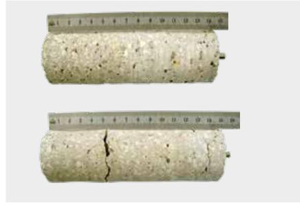
Abb. 8.4.1: Probekörper vor und nach einem Sulfatangriff. Die Belastung führte zu einer Längenzunahme des Probekörpers was schliesslich zu Rissen und Abplatzungen führen kann.
