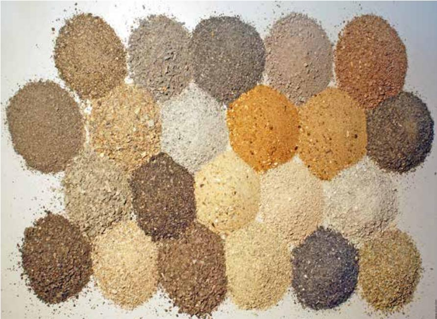
Für die Betonherstellung geeigneter Sand wird weltweit immer mehr zu einem seltenen Rohstoff. Auch wenn man mit Blick auf die Wüsten dieser Erde meinen könnte, dass Sand unendlich vorhanden sein müsste, ist genau das nicht der Fall. Gerade Wüstensande sind wegen ihrer extrem glatten Oberfläche für Beton ungeeignet. Beim Auftreten von Sandproblemen sind vor allem zwei Aspekte zu berücksichtigen:
