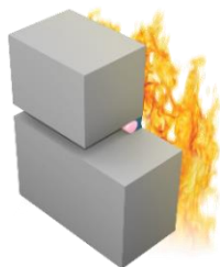
T3 Joint simple, côté exposé au feu et n'importe quelle position à l'intérieur du mur
