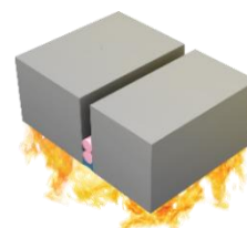
H5 Double couche de Sika® Backer Rod Fire Joint simple et n'importe quelle position à l'intérieur du mur
