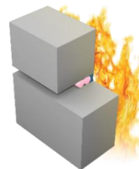
T5 Double couche de Sika® Backer Rod Fire Joint simple et n'importe quelle position à l'intérieur du mur
