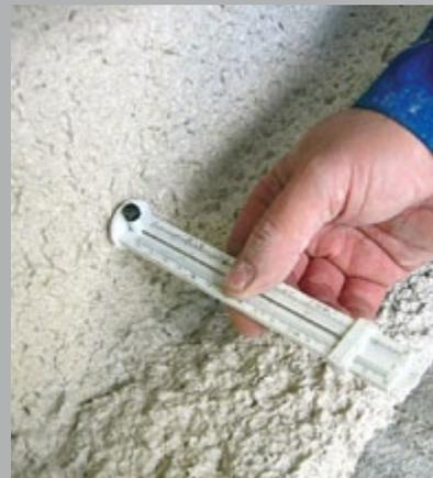
Misurazione dello spessore dello strato dopo l'applicazione del rivestimento finale
