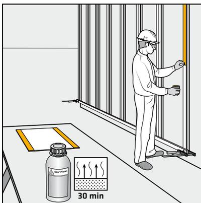
Agitare bene il flacone di SikaTack® Panel Primer (il movimento delle sfere in acciaio all'interno si deve sentire bene). Applicare uno strato sottile e regolare di SikaTack® Panel Primer tramite un pennello in gormapiuma.
