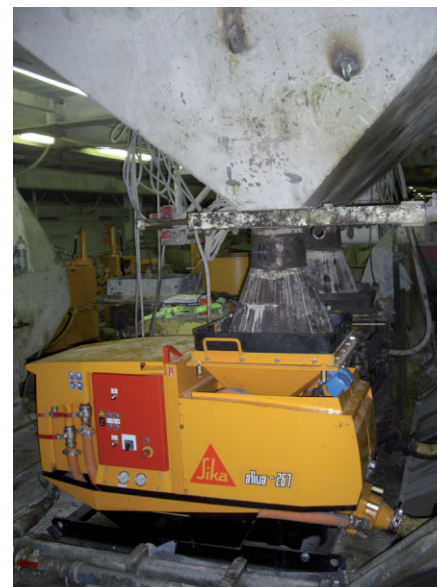
Fig. 3. The AL - 267 on a TBM for backfilling of pea gravel in segmental lined tunnel Bild 3. Einsatz der AL - 267 im maschinellen Tunnelbau zur Verfüllung des Ringspalts zwischen Tübbing und Gebirge mit Perlkies
