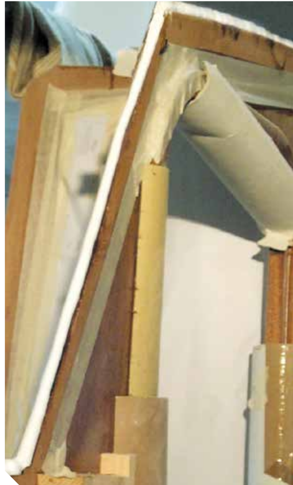
Sikaflex®-292i auf einer Leichtbauplatte vor der Verklebung
