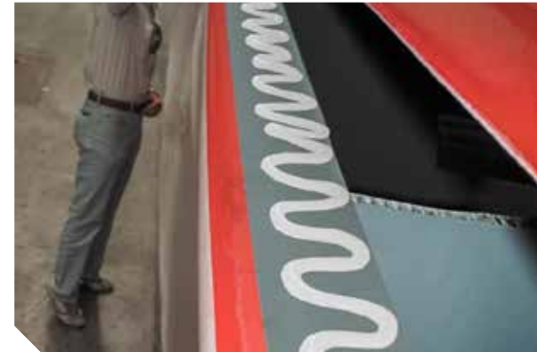
Sikaflex®-292i wird dickschichtig auf die Verbindungsfläche aufgetragen
