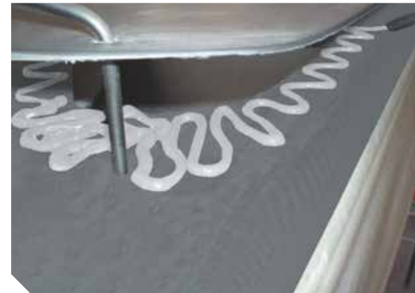
Ein Fixierstift hilft zur genauen Ausrichtung der Kleberaupe
