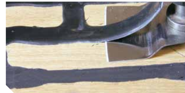
Entfernen von überschüssigem 290 DC PRO mit einem oszillierenden Schaber
