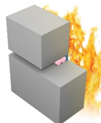
T5 Doppelte Lage Sika® Backer Rod Fire Einzelfuge und jede Position innerhalb der Wand
