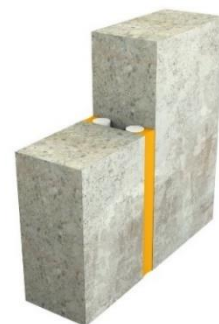
Leichte (links) und massive (rechts) Wände mit Durchführungsöffnung und Fugendichtung
