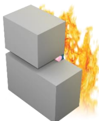
T3 Einzelfuge, feuerzugewandte Seite und jede Position innerhalb der Wand
