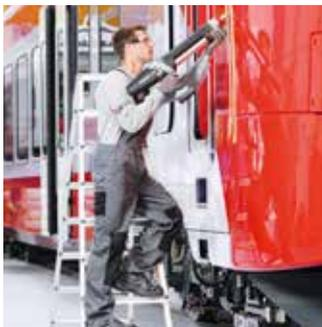
In vielen Märkten spielen neben der Qualität die Kosten eine zentrale Rolle. Daher liegt der Fokus auf der Vereinfachung von Prozessen, um das Fehlerrisiko zu minimieren und Prozesszeiten zu verkürzen. Unsere beschleunigten und zweikomponentigen Produktsysteme erfüllen dies, da sie keine Wärme zur Aushärtung benötigen und nur eine geringe Untergrundvorbehandlung verlangen.
