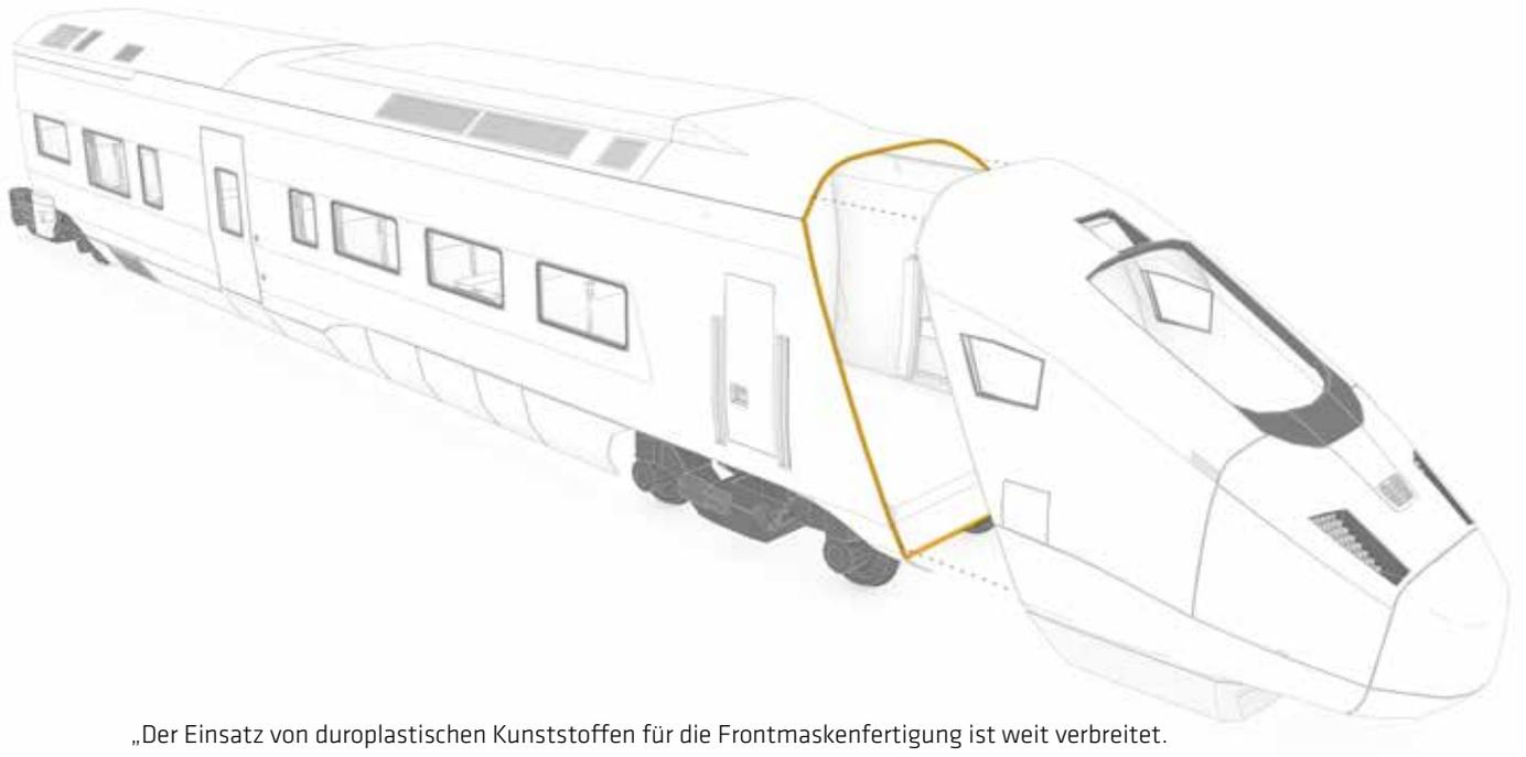
„Der Einsatz von duroplastischen Kunststoffen für die Frontmaskenfertigung ist weit verbreitet. Dies trägt zu optimierten Fertigungsprozessen sowie einer deutlichen Fahrzeuggewichtsreduzierung bei. Sika Kleb- und Dichtstofflösungen gewährleisten langlebige Bauteile für Frontmasken, die ständig dynamischen Belastungen ausgesetzt sind.“
