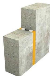
Parete leggera (a sinistra) e parete piena (a destra) con attraversamento e sigillatura dei giunti
