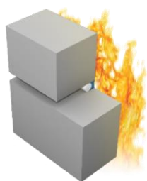
T3 Giunto singolo, lato esposto al fuoco
