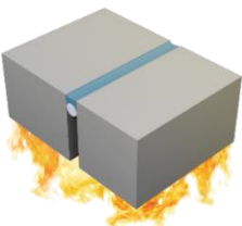
H2 Giunto singolo a pavimento, lato opposto al fuoco
