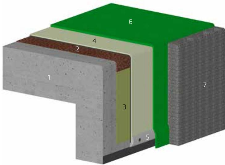
Abbordungen sind 200 mm unter die Fuge Decke-Wand zu führen und rückstausicher mit der vertikalen Abdichtung zu verbinden.
