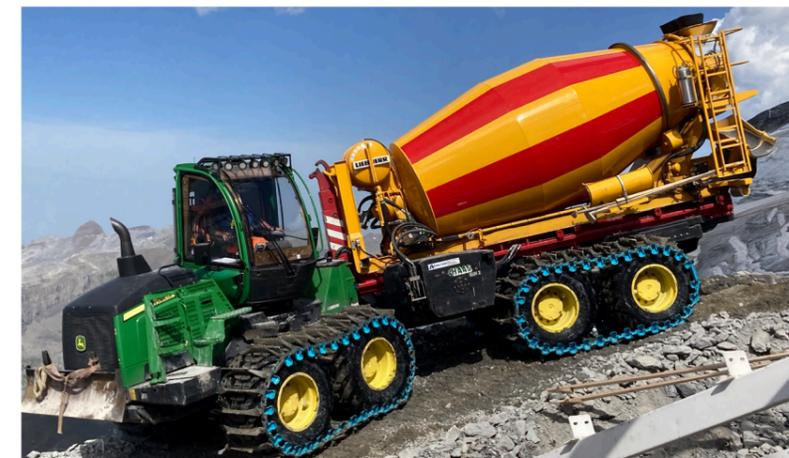
Ein Forwarder (Tragrückenschlepper) wird als Betonfahrmaschine im Gletschergelände genutzt.
