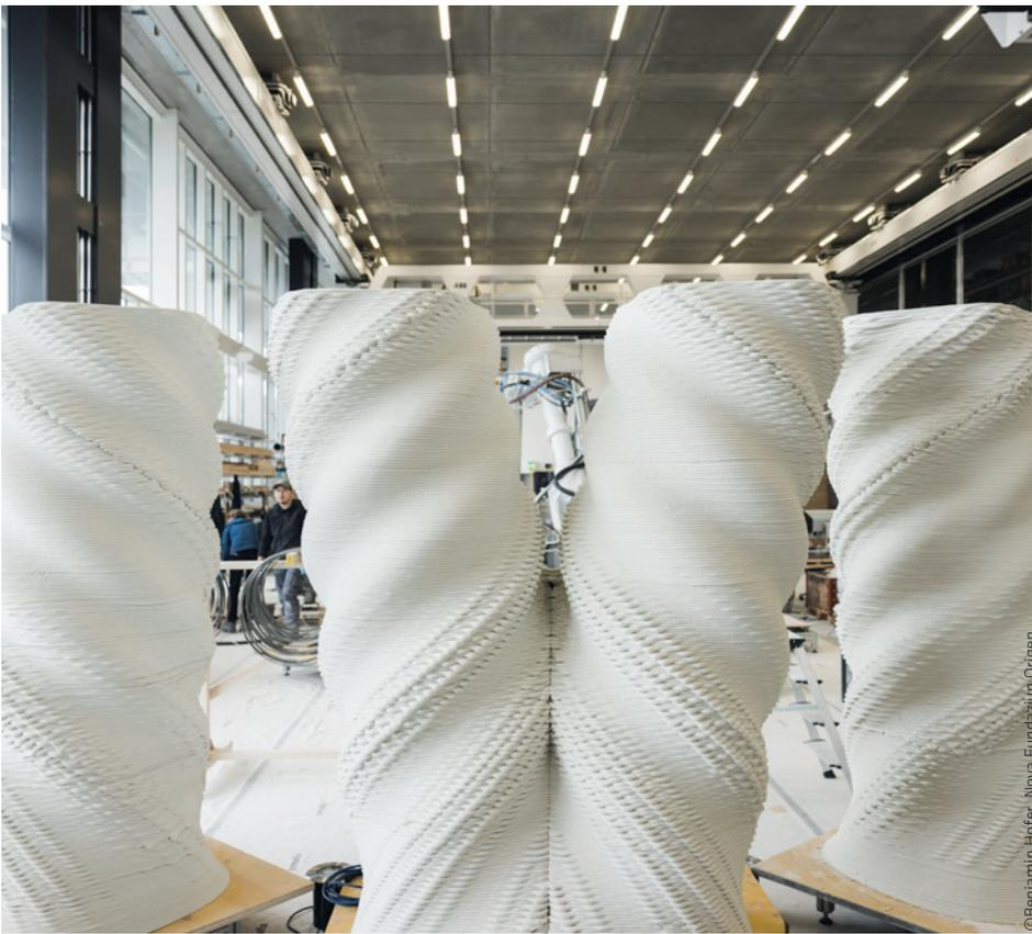
Volltragende, 3D-gedruckte Säulen, deren Stahlbewehrung während des Druckprozesses integriert wird: Das ist eine absolute Weltpremiere.
