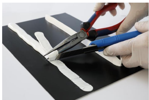
Figure 5: Tourner le cordon de colle, afin d'obtenir une tension maximale et une coupe
