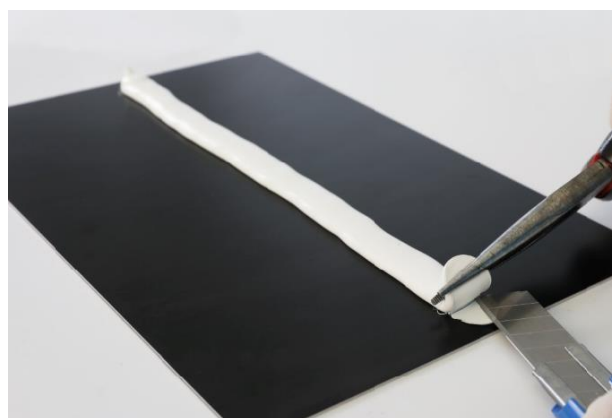
Figure 4: Après durcissement complet, détacher les 3 premiers cm du cordon
