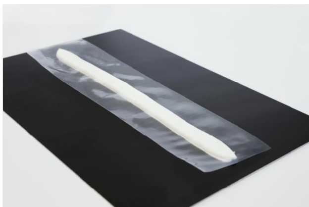
Figure 3: Presser le cordon de colle à mi-hauteur
