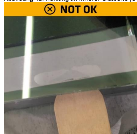
Abbildung 44: Resultat – Haftverlust an Glasoberfläche (nicht OK)
