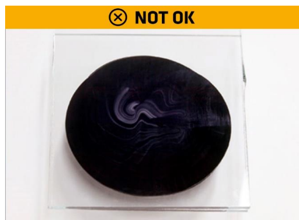
Abbildung 3: Negativer Test = mangelhafte Mischung
