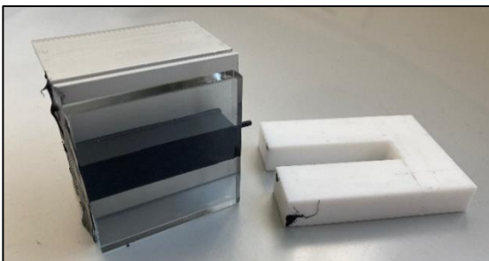
Abbildung 20: Den weissen, U-förmigen Teflonabstandhalter nach der entsprechenden Aushärtezeit (siehe oben) entfernen.
