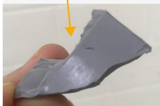
Abbildung 38: Keine Adhäsion an der Glasinnenseite, nicht in Ordnung
