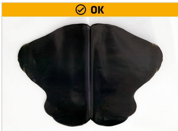
Abbildung 6: Folie auffalten - Positiver Test = gute Mischung
