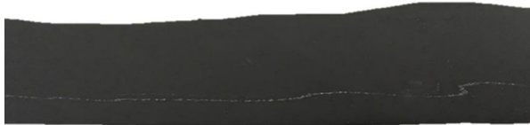
Abbildung 10: Weisse Streifen im Material, inhomogene Mischung
