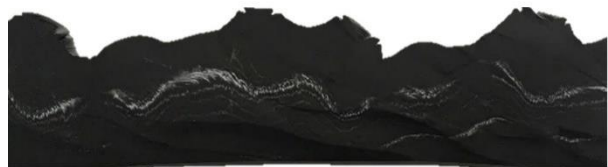
Abbildung 11: Deutliche weisse Streifen im Material, inhomogene Mischung
