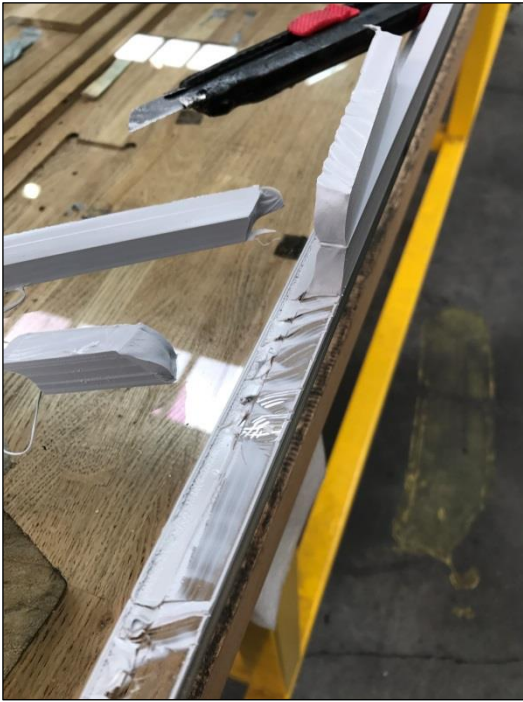
Abbildung 30: Gute Haftung, Entglasungstest bestanden
