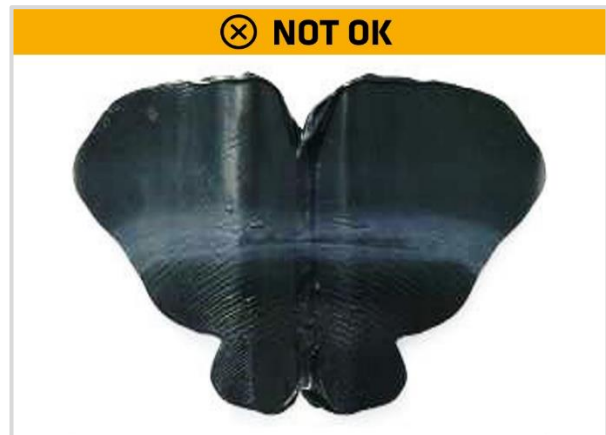
Abbildung 7: Folie auffalten - Negativer Test = ungenügende Mischung
