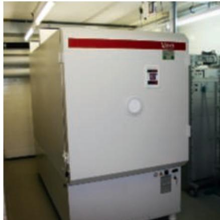
**Bild 1: 1-m<sup>3</sup>-Emissionskammer mit online-FID. Bild: Sika Technology AG**
