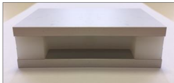
Figura 25 – Provini alternativi (adatti per profili e prodotti monocomponenti)
