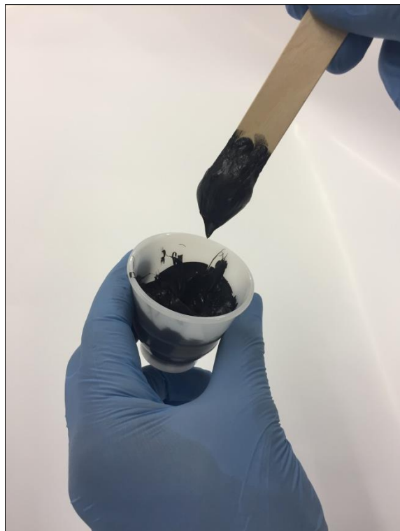
Figura 12 – Il materiale ha un comportamento gommoso: il tempo di impiego (inizio della reticolazione) è stato raggiunto.
