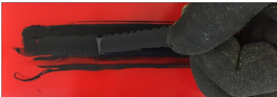
Figura 18 – Peel test: il cordone viene tirato dal substrato, modello di frattura 100% coesiva
