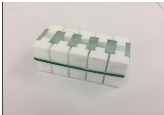
Figura 21 – Provini assemblati e fissati con elastici e nastro adesivo
