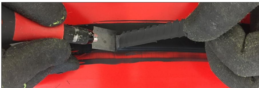
Figura 19 – Peel test su vetro smaltato: il cordone viene intagliato sotto trazione
