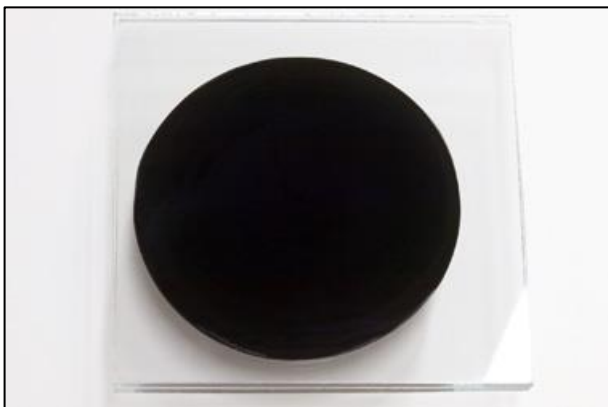
Figura 4 – Risultato positivo del test = miscelatura ideale
