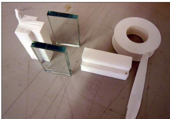
Figura 20 – Distanziatori, nastro di ePTFE (necessario per adesivi monocomponenti) e substrati (ad es. vetro)
