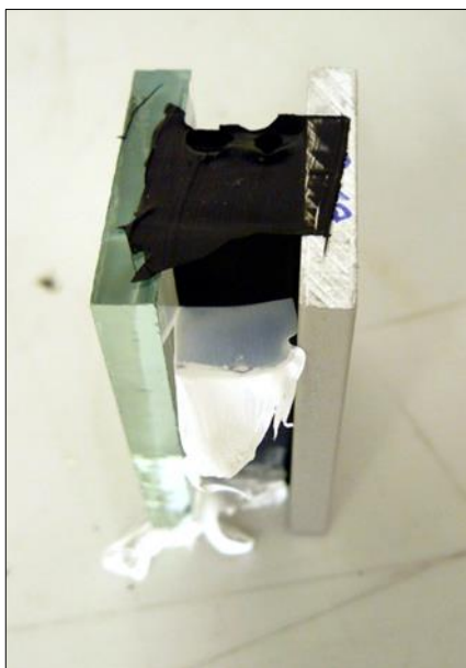
Figura 24 – Rimozione dei distanziatori dopo 1 giorno, il nastro ePTFE dopo 7 giorni (prodotti monocomponenti)
