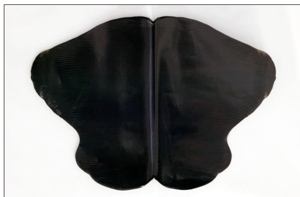
Figura 8 – Riaprire il foglio; risultato positivo del test = buona miscelatura
