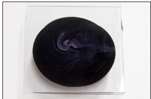
Figura 5 – Risultato negativo del test = miscelatura lacunosa
