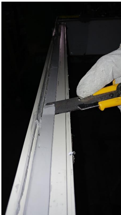
Figura 29 – Verifica dell'adesività lungo l'intero perimetro del telaio: buon risultato di adesione.
