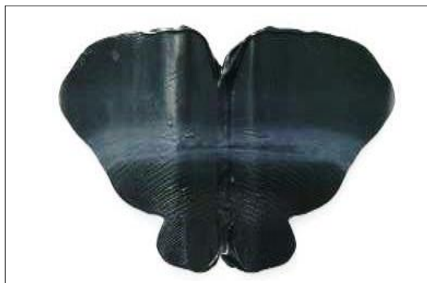
Figura 9 – Risultato negativo del test = miscelatura insufficiente
