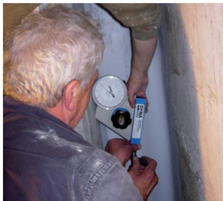
Haftzugprüfung am Sikadur-Combiflex-Fugenabdichtungssystem im Zuge der Qualitätssicherung.
