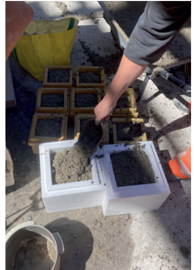
Frischbetonproben auf 3000 Metern Höhe (Sika Baustoff-Prüflabor).
