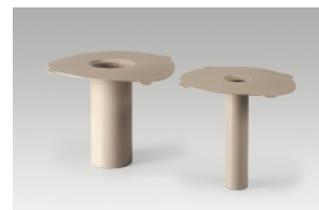
Le bocchette di scarico Sarnafil in PP sono accessori "stampati per iniezione" in PP rigido. Esse sono resistenti alle intemperie, ai raggi UV ed alla compressione e possono essere utilizzate solo con i Sistemi di coperture Sarnafil a base di T. Le bocchette di scarico 50, 56, 63, 75, 90, 110, 125 e 160 mm rispettano le regole tecniche DIN 19599 in collegamento con le norme EN 1253.
