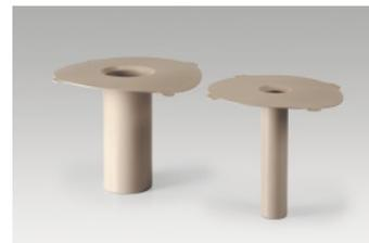
Les naissances Sarnafil T sont fabriquées avec du PP dur injecté. Elles présentent une grande résilience ainsi qu'une bonne stabilité dimensionnelle et aux UV. Elles ne peuvent être mises en œuvres que sur un système de toit en Sarnafil T. Les naissances 50, 56, 63, 75, 90, 110, 125 et 160 mm sont fabriquées dans le respect de la norme DIN 19599 et remplissent les exigences de la norme EN 1253.
