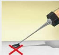
A chaque nouvelle cartouche ou après l'échange du mélangeur statique, le matériau extrudé par les premiers coups de pompe ne doit pas être utilisé avant ce que le mélange soit homogène.
