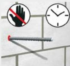
Pendant le temps de durcissement, l'ancrage ne doit en aucun cas être bougé ou chargé.
