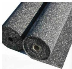
La natte de protection s'emploie dans la protection mécanique du Sarnafil T et du Sarnafil PVC, en particulier lors de charges importantes comme par exemple sur les parkings. Pour des raisons de compatibilités, le Sarnafil PVC nécessite une couche de séparation qui peut être du Sarnafelt T 300 ou Sarnafelt VS 140.
