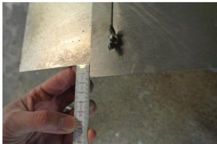
La truelle réglable doit être ajustée à une profondeur de 15 mm.
