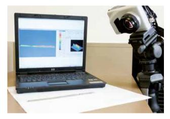
Sika System Engineering unterstützt die Optimierung der Klebstoffapplikation durch patentierte Testmethoden. Das obige Bild zeigt eine Infrarotkamera, die die Reaktionswärme von Klebstoffen misst.
